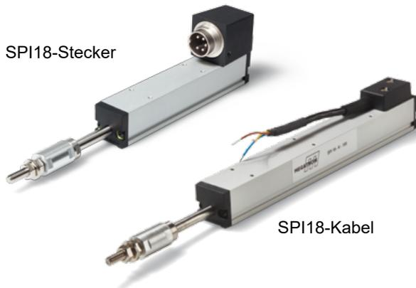
Bei der Wegaufnehmerserie SPI18 erfolgt die mechanische Erfassung der Linearbewegung über die einseitig geführte Schubstange. Zum Ausgleich von vertikalem und horizontalem Versatz ist die Schubstange zur mechanischen Ankopplung mit einer Kugelkupplung ausgeführt. Das kompakte und robuste Gehäuseprofil der Baureihe SPI18 aus eloxiertem Aluminium entspricht dem gängigen Industriemaß von 18x18 mm im Profil.
