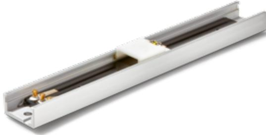
Die Serie CFL ist für Messlängen von 100...500 mm mit einem hochauflösenden Leitplastik-Widerstandselement mit Mitnehmerschlitten ausgestattet.
