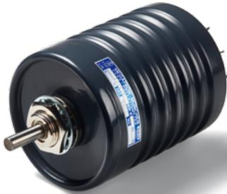
Die Potentiometer der Serie OF50 sind mit Öl gefüllt. Das Öl hat eine Wärme ableitende Funktion, reinigt das Widerstandselement von Abrieb und schützt es vor Feuchtigkeit sowie aggressiven Stoffen.
