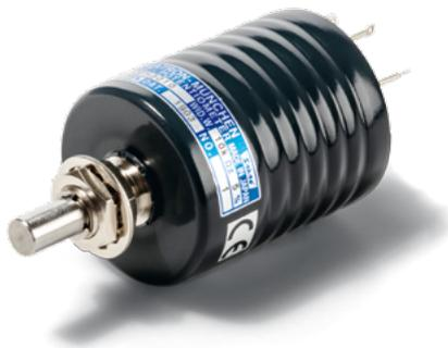
Die Potentiometer der Serie OFH sind mit Öl gefüllt. Das Öl hat eine Wärme ableitende Funktion, reinigt das Widerstandselement von Abrieb und schützt es vor Feuchtigkeit sowie aggressiven Stoffen.
