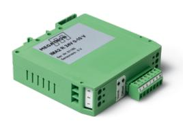
Der Messverstärker IMA2-R dient zur Umwandlung der Ausgangssignale von potentiometrischen Sensoren in normierte Ausgangssignale. Der angeschlossene Sensor wird vom IMA2 standardmäßig mit 5 V (optional 10 V) gespeist. Am Ausgang stehen wahlweise die wichtigsten genormten Analogsignale zur Verfügung (0..5 V, 0..10 V, ±5 V, ±10 V, 0..20 mA, 4..20 mA). Die gesamte Elektronik ist in einem Phoenix-Gehäuse (UEGM) für Tragschienenmontage untergebracht.
