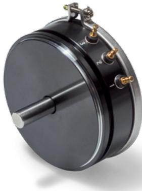
Die Potentiometer der Serie MCP50 mit Präzisionskugellagern und Servoflansch sind für Applikationen, bei denen es auf eine sehr hohe Lebensdauer des Sensors mit äußerst guter Linearität, hohem Widerstandswert bei hoher Belastbarkeit und präziser Montage ankommt.
