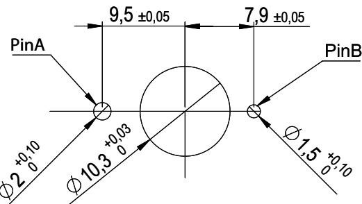
Als Verdrehschutzpin muss entweder Pin A oder Pin B gewählt werden. Bitte wählen Sie durch Angabe der Variante im Bestellcode. Der nicht verwendete Pin kann bei der Bohrung weg gelassen werden.
