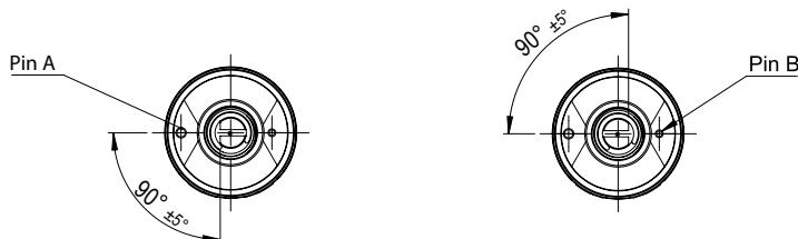
**Signaldefinition für benutzerdefinierte Drehwinkel (ohne mechanischem Anschlag)**
