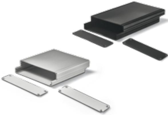
Die Aluminium-Kleingehäuse der Serie EUKAP FS sind für Europakarten mit einer Breite von 100 mm und einer Dicke von max. 1,8 mm ausgelegt. Die Gehäuse sind in 6 verschiedenen Höhen (18..46 mm Innenhöhe) und in den Standardlängen 80/100/160 mm (optional weitere) erhältlich. Die Gehäuse werden als Bausatz bestehend aus 2 Profilen, 2 Endplatten inkl. Schrauben geliefert. Die Oberfläche ist Aluminium eloxiert oder Aluminium schwarz eloxiert.
