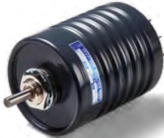
Die Potentiometer der Baureihe OF50 sind ölgefüllt. Das Öl hat eine Wärmeableitfunktion, reinigt das Widerstandselement von Abrieb und schützt es vor Feuchtigkeit und aggressiven Stoffen.
