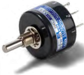
Die Potentiometer der Baureihe OF30 sind ölgefüllt. Das Öl hat eine Wärmeableitfunktion, reinigt das Widerstandselement von Abrieb und schützt es vor Feuchtigkeit und aggressiven Stoffen.
