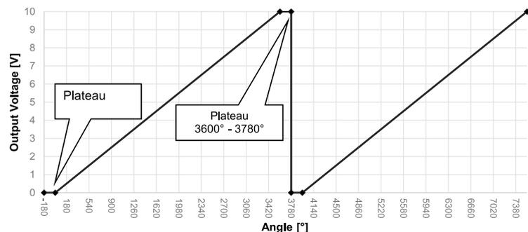
Die Zeichnung zeigt den Amplitudenverlauf eines 0...10 V Ausgangssignals
