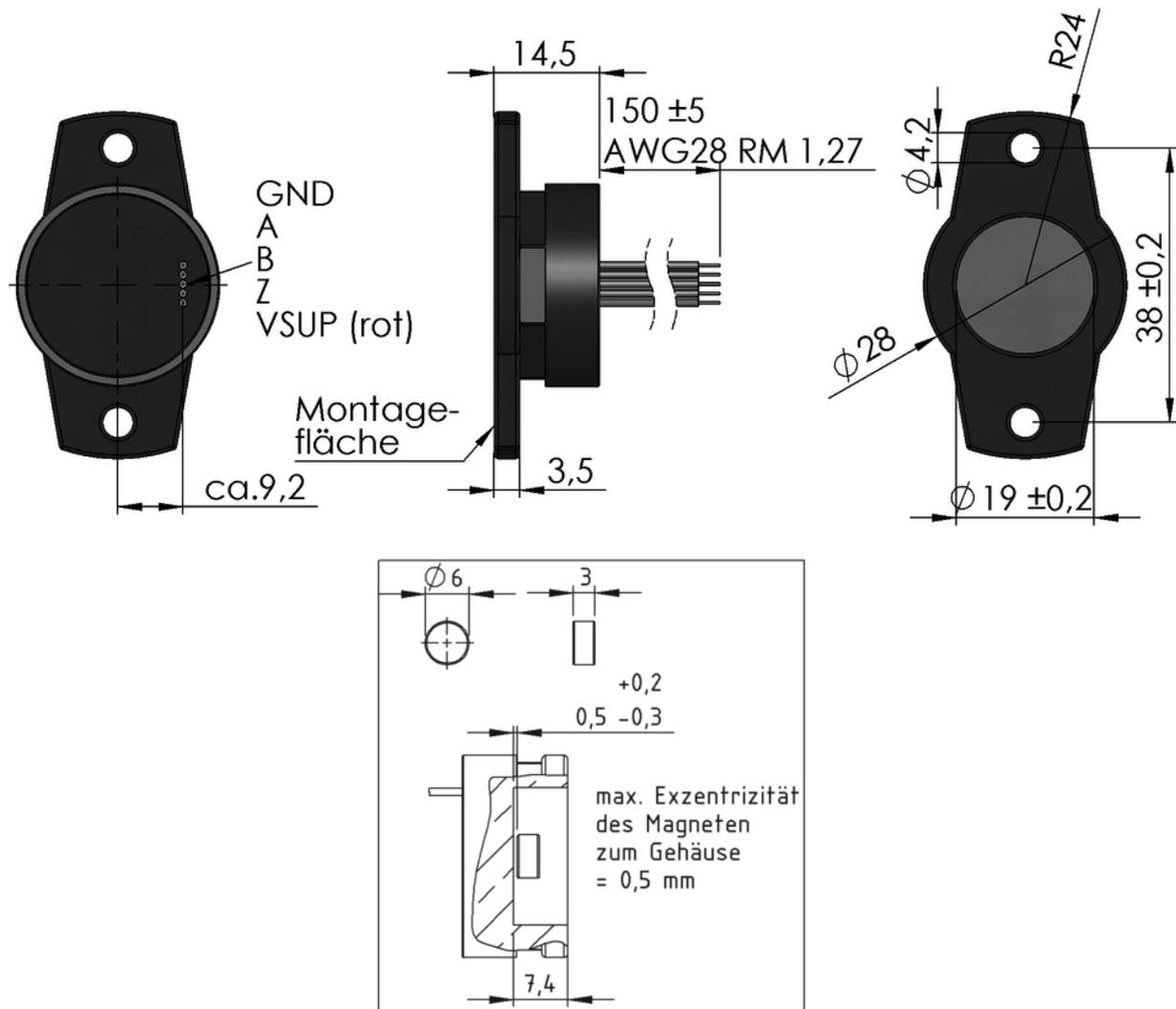
Falls die Welle magnetisch ist, ist ein Minimalabstand von  $\geq 1$  mm zwischen Magnet und Welle einzuhalten.
