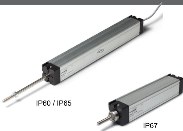
Die Serie MMS33 ist ein potentiometrischer Wegsensor in robuster Ausführung mit Schutzart IP60 (optional IP65/ IP67). Die mechanische Erfassung der Linearbewegung erfolgt über die einseitig geführte Schubstange. Zum Ausgleich von vertikalem und horizontalem Versatz kann auf die Schubstange eine Kugelkupplung oder ein Gelenkkopf aufgeschraubt werden (nicht im Lieferumfang enthalten).
