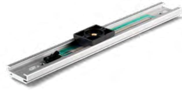
Die Serie MBF zeichnet sich besonders durch ihre geringe Bauhöhe von < 14 mm und ihr minimalistisches Design aus. Der Mitnehmerschlitten ist komfortabel für eine direkte und platzsparende Integration in die Applikation gestaltet. Der elektrische Anschluss des Wegsensors erfolgt über den integrierten Crimpstecker. Ein passender Gegenstecker mit Kabel ist als Zubehör erhältlich (nicht im Lieferumfang enthalten).
