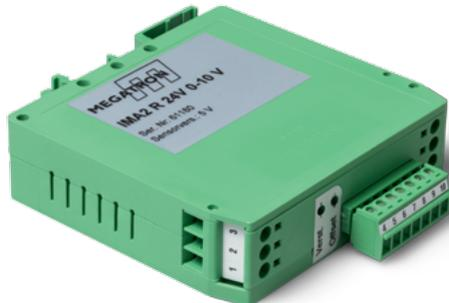
Der Messverstärker IMA2-R dient zur Umwandlung der Ausgangssignale von potentiometrischen Sensoren in normierte Ausgangssignale. Der angeschlossene Sensor wird vom IMA2 standardmäßig mit 5 V (optional 10 V) gespeist. Am Ausgang stehen wahlweise die wichtigsten genormten Analogsignale zur Verfügung (0..5 V, 0..10 V,  $\pm 5$  V,  $\pm 10$  V, 0..20 mA, 4..20 mA). Die gesamte Elektronik ist in einem Phoenix-Gehäuse (UEGM) für Tragschienenmontage untergebracht.
