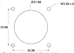
Der Joystick wird von der Panelunterseite aus in die Montagebohrung eingesetzt. Der Balg wird komplett durch die Montageöffnung geführt und an der Paneloberseite durch den Montagering fixiert. Für Paneldicken < 3 mm werden M3x16 Senkschrauben empfohlen.Bitte beachten Sie, dass die Montagebohrung nicht
