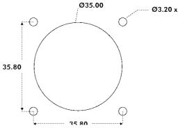
Der Joystick wird von der Panelunterseite aus in die Montagebohrung eingesetzt. Es werden M3 Maschinenschrauben zur Montage empfohlen.
