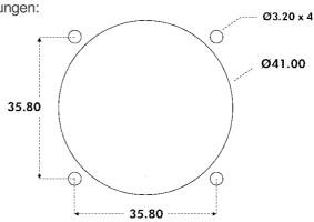
Der Joystick wird von der Paneloberseite aus in die Montagebohrung eingesetzt. Für Paenldicken < 3 mm werden M3x16 Senkschrauben empfohlen.
