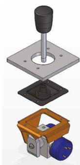
Der Joystick wird von unten montiert. Die Gewindebohrungen sind vom Typ M2,5.
