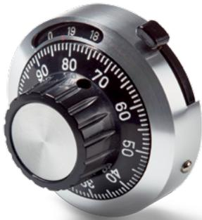
**Einstellknopf NKK im Ø46 mm Gehäuse mit 100 Stricheinteilung, Umdrehungszähler (20Udr.), Feststellbremse und Kardankupplung**
