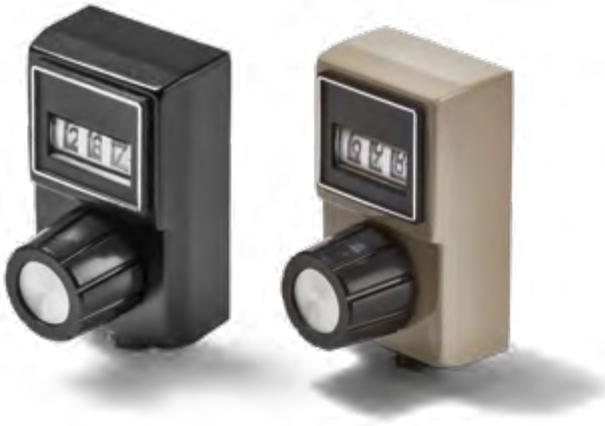
**Der Einstellknopf im 26 x 44 mm Gehäuse mit 3-stelliger Ziffernrolle für 10 Umdrehungen und Feststellbremse.**
